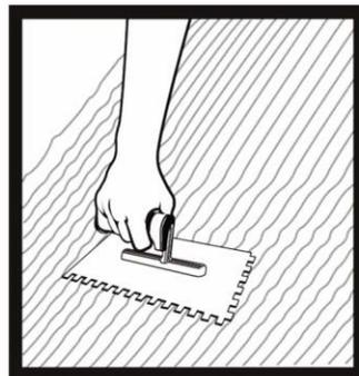
6. Aplique una capa de PegaReal PREMIUM GLOBAL utilizando la parte lisa de la llana. Agregue más pasta y extiéndala con la llana dentada en forma homogénea en un área de 1,0 a 1,5 m<sup>2</sup>. Aplicar adhesivo en la cara posterior de la pieza cerámica.
