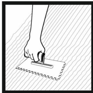
6. Aplique una capa de PegaReal BLANCO/GRIS utilizando la parte lisa de la llana. Agregue más pasta y extienda con la llana dentada en forma homogénea en un área de 1,0 a 1,5 m<sup>2</sup>.
